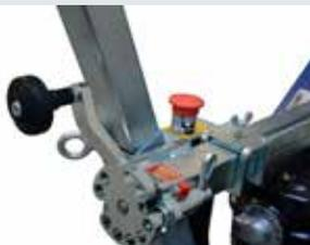
Фиксатор глубины реза
